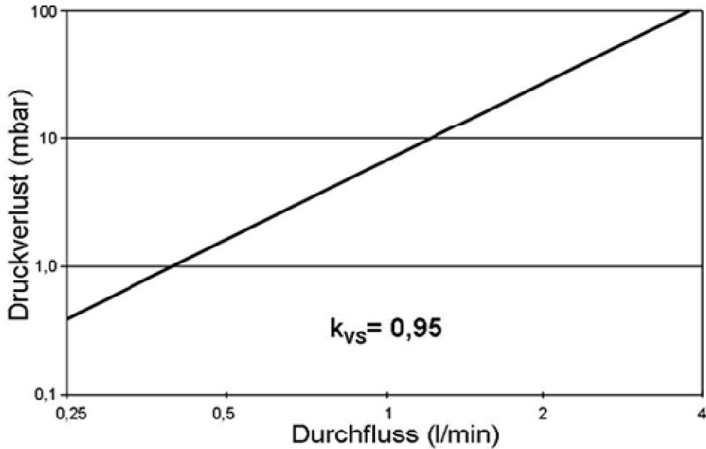
**Druckverlust Multibox K und K-RTL**
