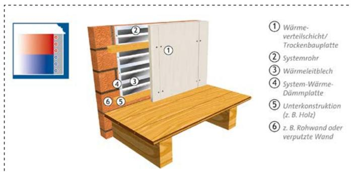
Das Systemrohr befindet sich bei der Wandheizung/-kühlung in Registerbauweise (Trockenbau) in den Wärmeleitblechen der Systemplatte.
