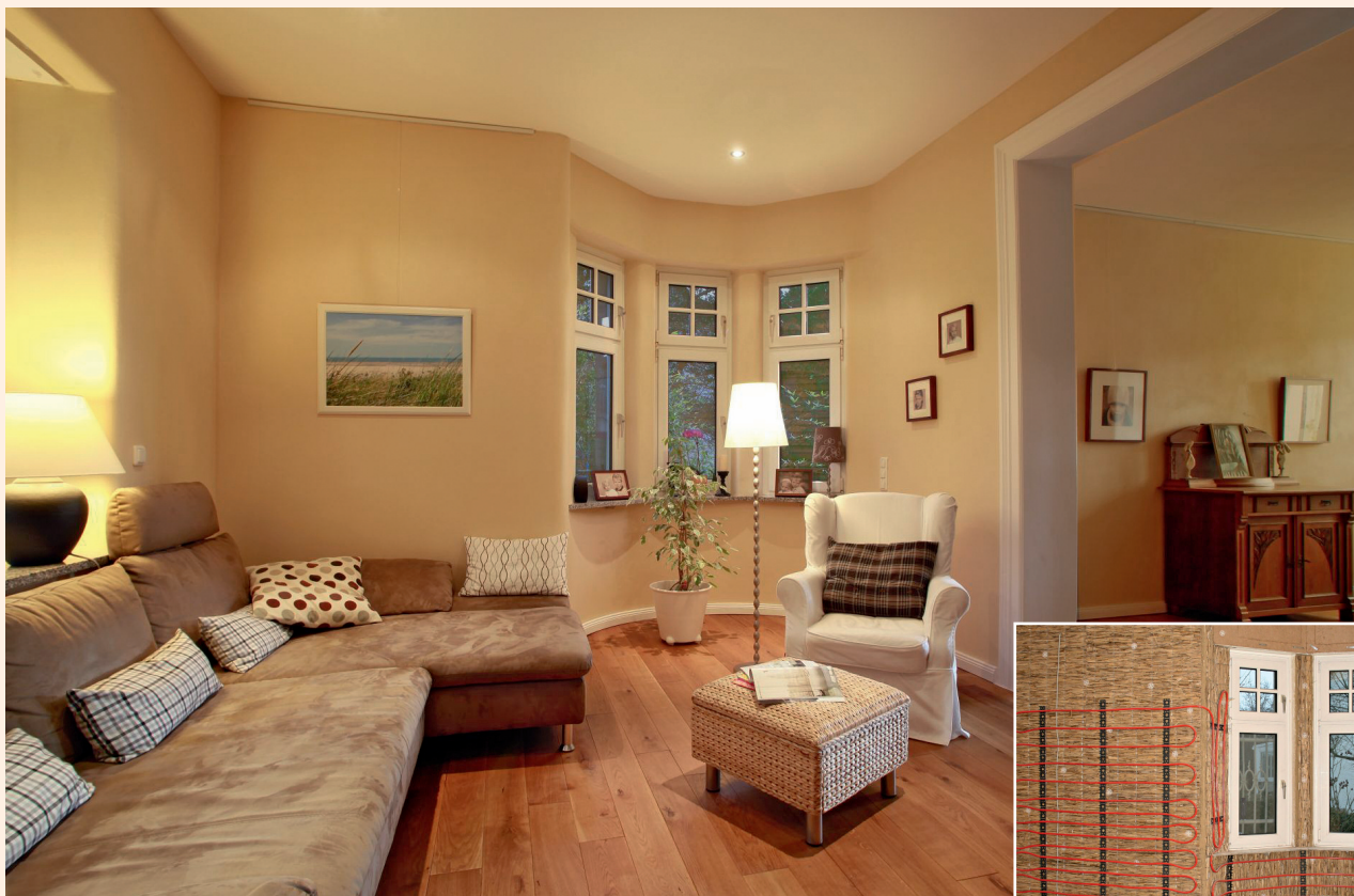
1 + 2 Bei dieser Villa wurde wegen der höheren Flexibilität das WEM Klimarohrsystem gewählt. Der Stuckateur verlegte die Rohrleitungen auf der Schilfrohrdämmung und verputzte sie mit Lehmputz.
