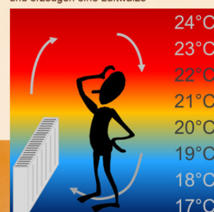
Heizkörper erwärmen die Raumluft und erzeugen eine Luftwalze
