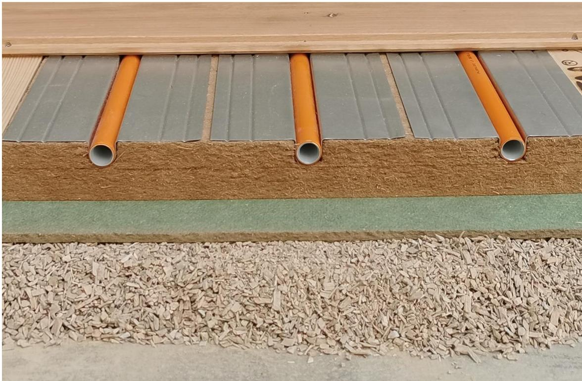
**Beschreibung Bodenheizung** Die WEM Bodenheizung ist ein Trockenbausystem. Es besteht aus einer 40 mm starken Holzfaser-Verlegeplatte, in die Platte eingelegten Wärmeleitblechen und dem Ø 16 mm WEM Mehrschicht-Verbundrohr. Den Bodenbelag bilden meist Holzdielen oder Fliesen. Das Verlegen der Fliesen erfolgt auf einer Last-Verteilschicht (z.B. Fermacell Trockenestrichplatte). Bei Holzdielen kommt eine Profilleiste zum Einsatz.
